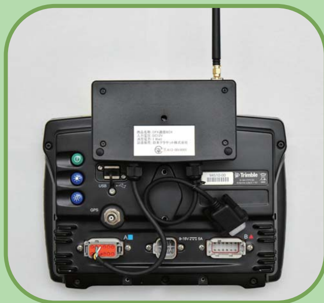
Trimble CFX-750にCFX-BOXを取付けた様子（実写）
