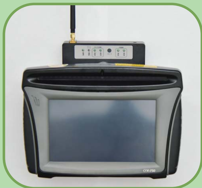
Trimble CFX-750にCFX-BOXを取付けた様子（実写）
