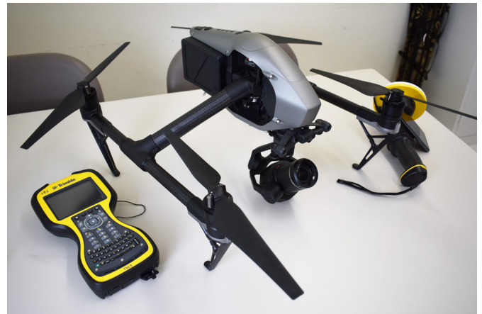
▲ SiteVision と空撮・測量用のドローン、Trimble TSC3
